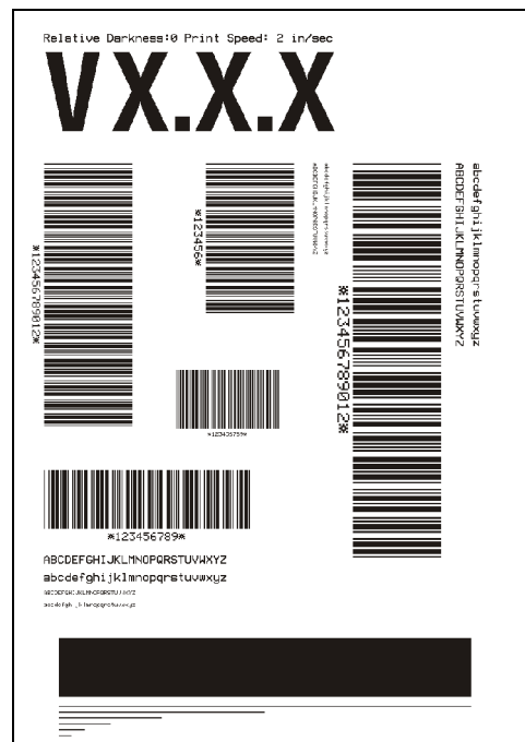
圖 31・FEED (送紙) 測試標籤
